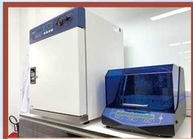
用作培養細菌的恆溫培養器及震盪培養箱
